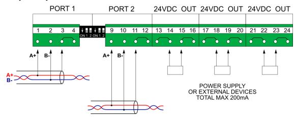
Fig. 6.14 Wiring diagram for 2RS485(24V) module.
