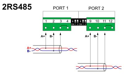
Fig. 6.15 Wiring diagram for 2RS485 module.
