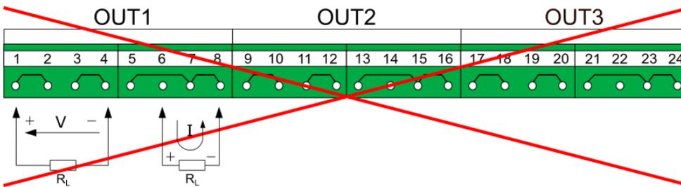
Fig. 6.20 The incorrect way wiring OUT3 module.
