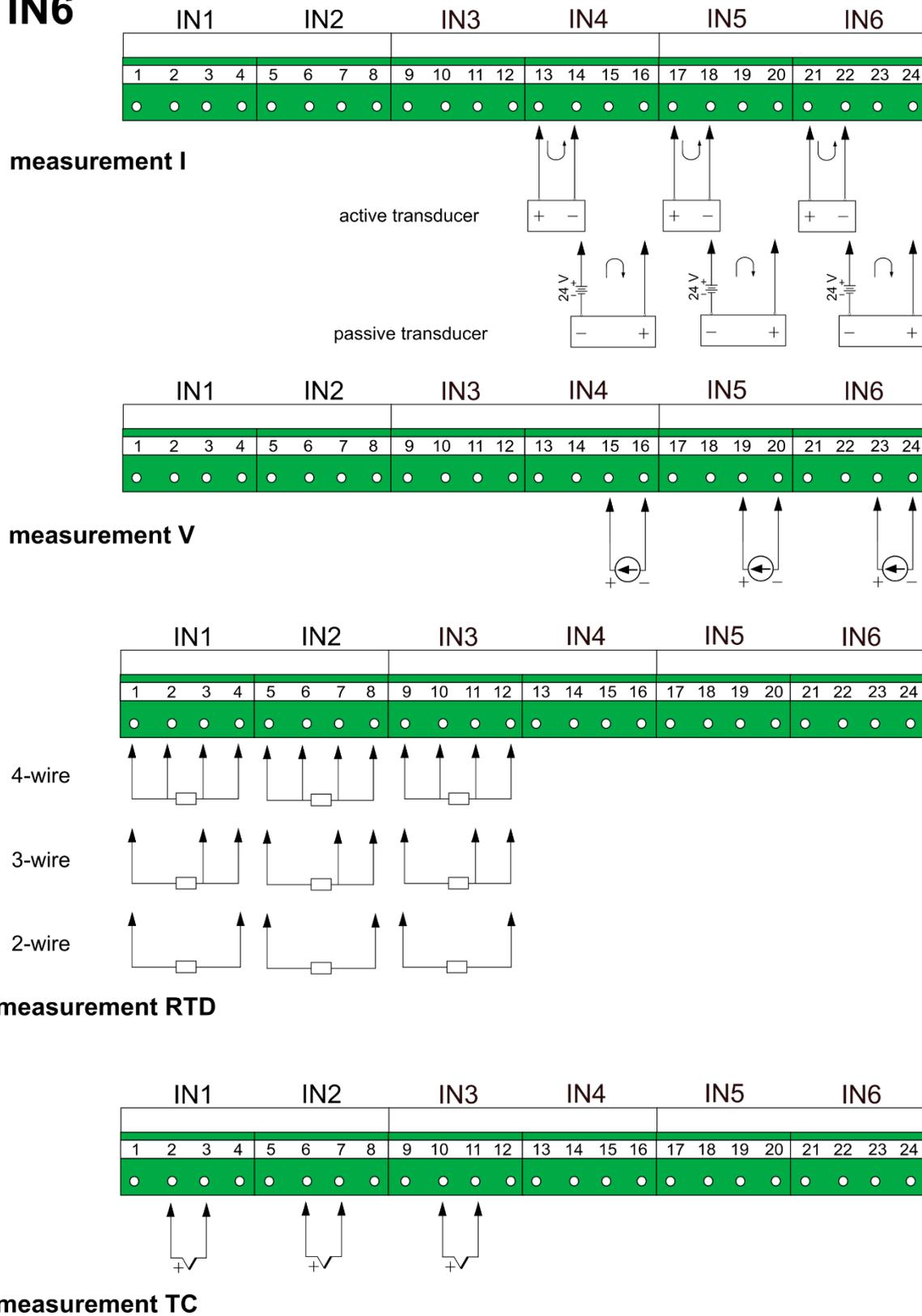
*Fig. 6.9 Wiring diagram for IN6 module.*
