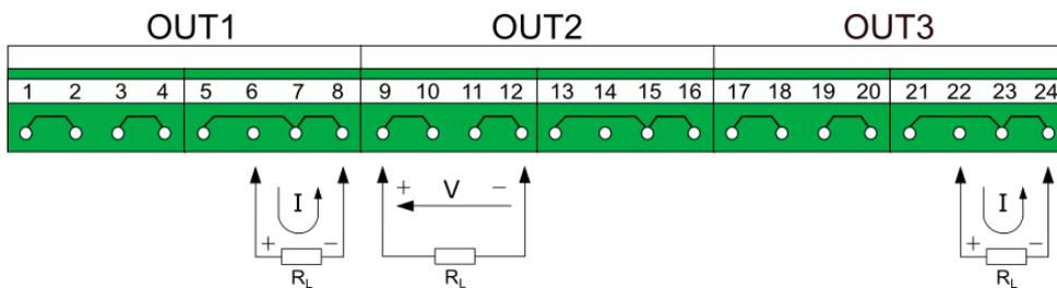
Fig. 6.19 The correct way wiring OUT3 module.
