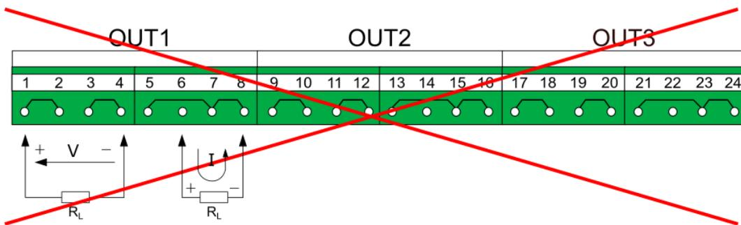
Fig. 6.19 The incorrect way wiring OUT3 module.
