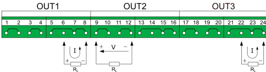
Fig. 6.18 The correct way wiring OUT3 module.
