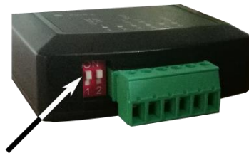
DIP-switch ON: terminacja RS-485 włączona
