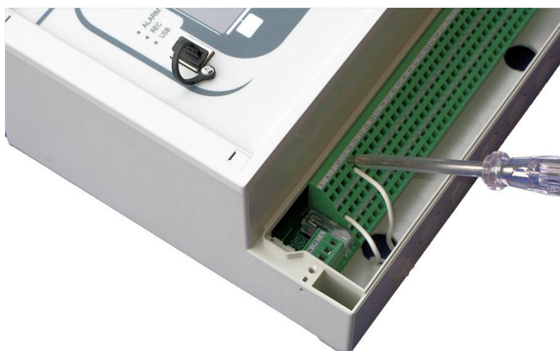
Rys. 14.3 Montaż przewodów
