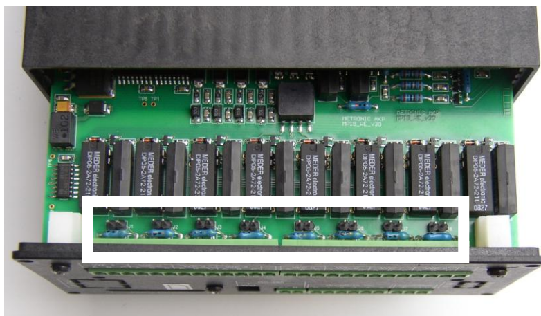
Piny do definiowania wejść wersji uniwersalnej: zwarcie – wejście analogowe, rozwarć – wejście temperaturowe
