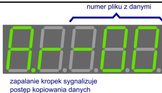
Rys. 1.1 Widok wyświetlacza przyrządu gdy w gnieździe USB znajduje się pamięć przenośna
