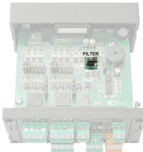
Rys. 2.10 Zwora załączająca / wyłączająca filtr
