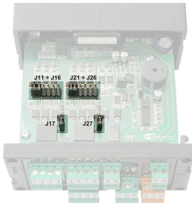
Rys. 2.9 Zwory do konfiguracji wejść analogowych
