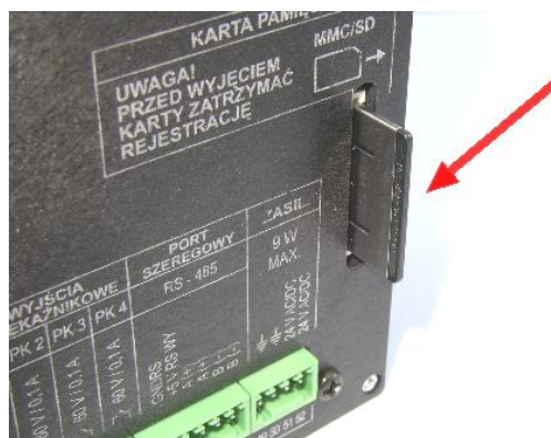
FP-3000. Gniazdo karty MMC/SD; analogicznie umiejscowione jest gniazdo w przyrządzie FP-3010
